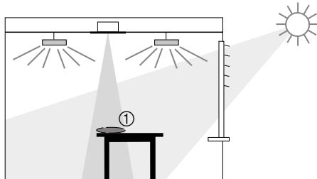
Коэффициент коррекции помещения = Освещенность на потолке / Освещенность на рабочей поверхности
